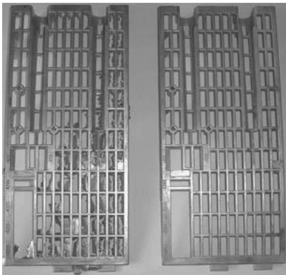
Bild Nr. 05-07 MK_B-Blende-vn.jpg. Benseler kann beim Entgraten innenliegender Grate auf über 35 Jahre Erfahrung zurückgreifen. Beispiel vorher-nachher (li.-re.).
