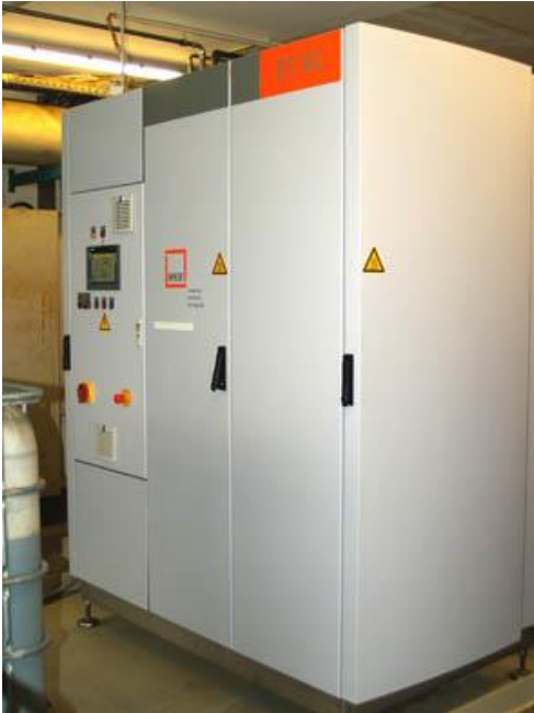
Bild Nr. 05-01 MK_B-ET50.jpg. Der Verdampfer ET50 von MKR Metzger hat eine Prozesswasserleistung von 50 l/h. Die Energiekosten sind sehr niedrig.
