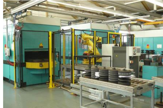
Bild Nr. 05-06 MK_B-TEM-Anlage.jpg. Beim Thermischen Entgraten werden alle am Werkstück vorhandenen Grate in einer Entgratkammer quasi verbrannt.
