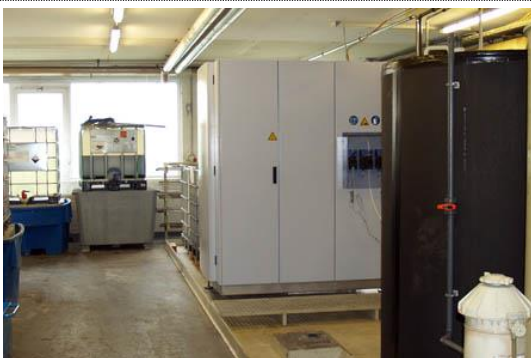
Bild Nr. 05-03 MK_B-ET50-back.jpg. Durch den Umstieg auf die Verdampfertechnologie von MKR Metzger hat Benseler Stellflächen hinzugewonnen.
