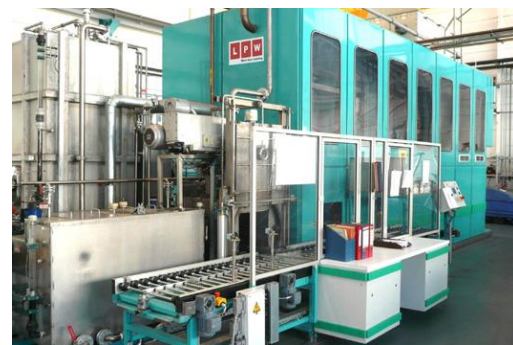
Bild Nr. 05-04 MK_B-Reinigung.jpg. Nach dem thermischen Entgraten folgt ein Reinigungsprozess, der bis zu vier Stufen umfassen kann.
