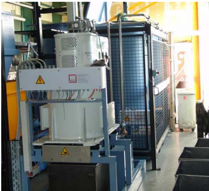
Foto 2 (050729-08) Die MKR-Zentrifuge 8000 T ist nahe der zwei Öl-Sammeltanks mit dem Schmutz-Öl platziert, deren Inhalt sie reinigt.
