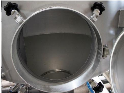
Alle Bauteile mit Kontakt zum Medium sind aus **Edelstahl** gefertigt.
