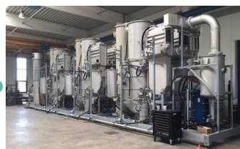
Seit 2016/17 mehrstufige Verdampfer mit bis zu 20.000 m³/a Reduzierung je Linie und >40.000 t/a Ansaugvolumen
