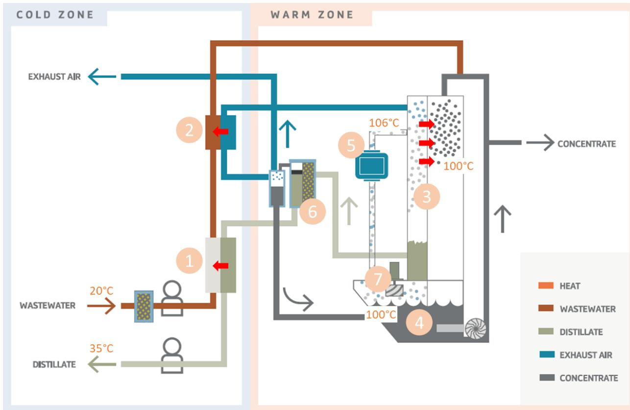
Das Medium gelangt über drei Wärmetauscher (1, 2 und 3) in den atmosphärischen Arbeitstank (4). Hier wird es umgewälzt und vom Hauptwärmetauscher (3) erhitzt.
