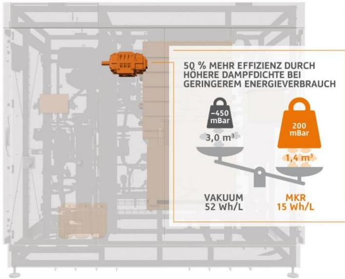
Der Verdichter verringert die mechanischen Arbeit durch höchste Dampfdichte (bis zu 50 % effizienter als Vakuumverdampfer). Durch eine 3-stufige Rekuperation wird ein geringer Energieverlust erreicht, was niedrige Energiekosten bedeutet.
