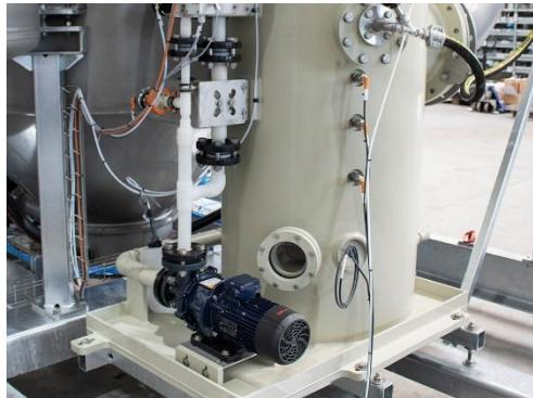
Bauteile für Schwefelsäure- und Brüdenwäscher sind ebenfalls aus hochwertigem **Edelstahl** und dadurch langlebig und korrosionsfrei.
