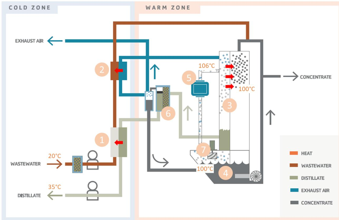
Bei ammoniakhaltigen Medien wird vor der Kondensation am Wärmetauscher (3) ein Brüdenwäscher installiert, um Ammoniak aus dem Dampf zu entfernen.
