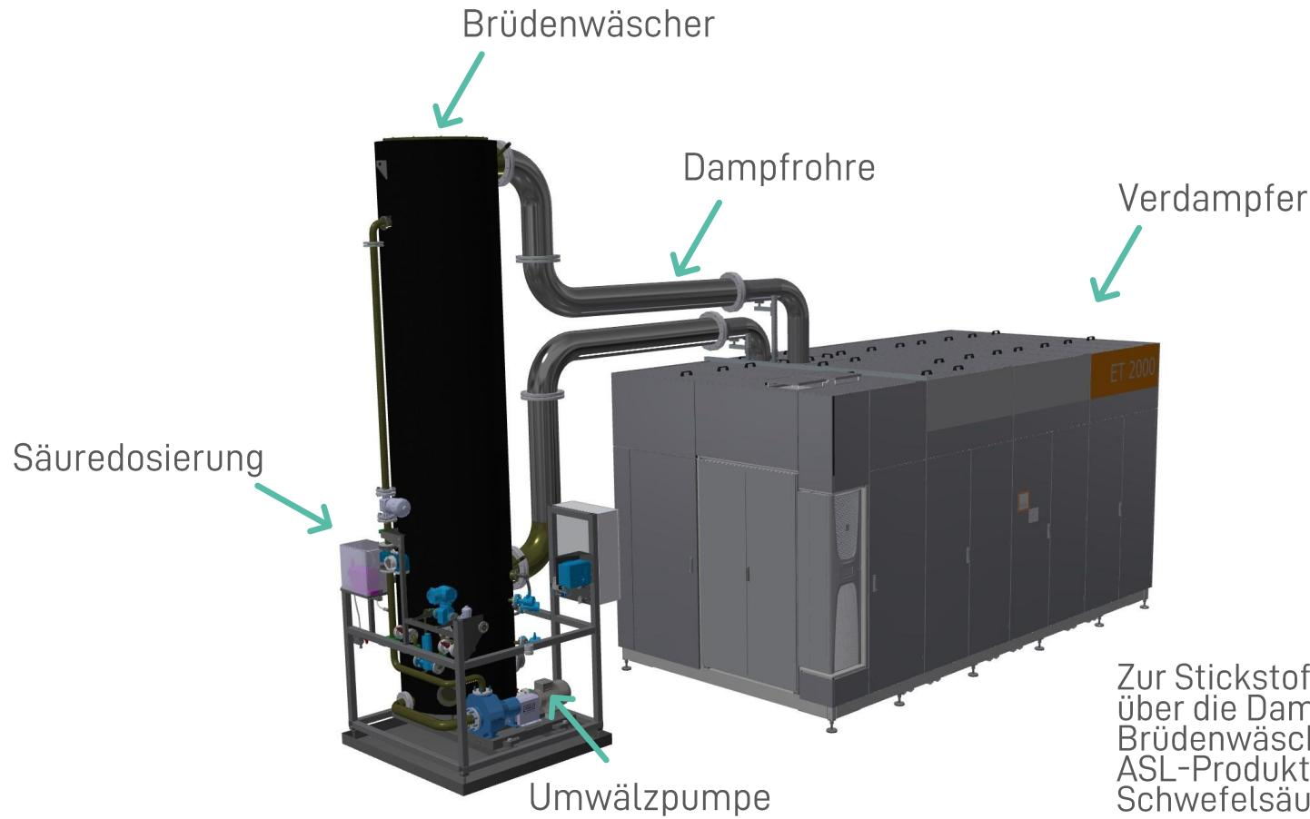
Zur Stickstoffbindung wird der Dampf über die Dampfrohre in den Brüdenwäscher geleitet und dort zur ASL-Produktion im Gegenstrom mit Schwefelsäure gewaschen.
